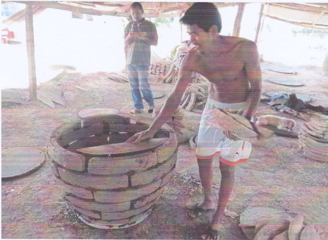
๓. ขึ้นรูปเสร็จ ใช้ไม้มาปิดปากโอ่งเตรียมดินเหนียวมาฉาบรอบตัวโอ่ง
